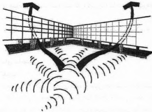
شکل ۲۱-۲-۵- تخلیه موج انفجار از پیلوت باز
