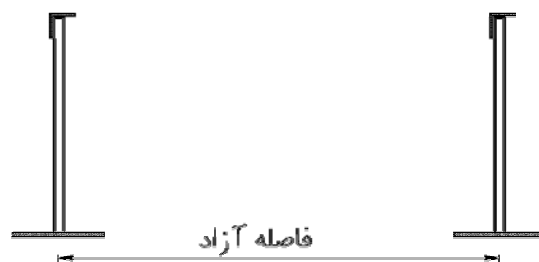
شکل ۸-۲- فاصله‌ی آزاد بین تیرچه‌های فولادی
