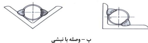
شکل ت ۴-۵ انواع اتصال با وصله جانبی
